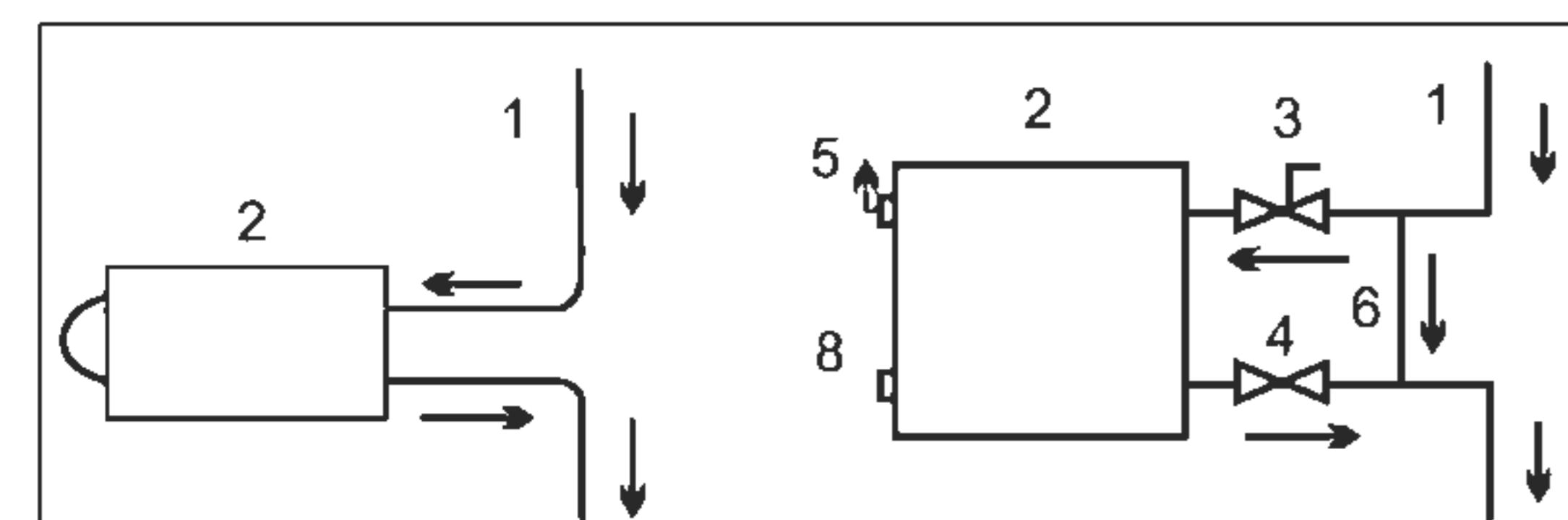
а — однотрубная система, б — однотрубная система, стандартное подключение с перемычкой
