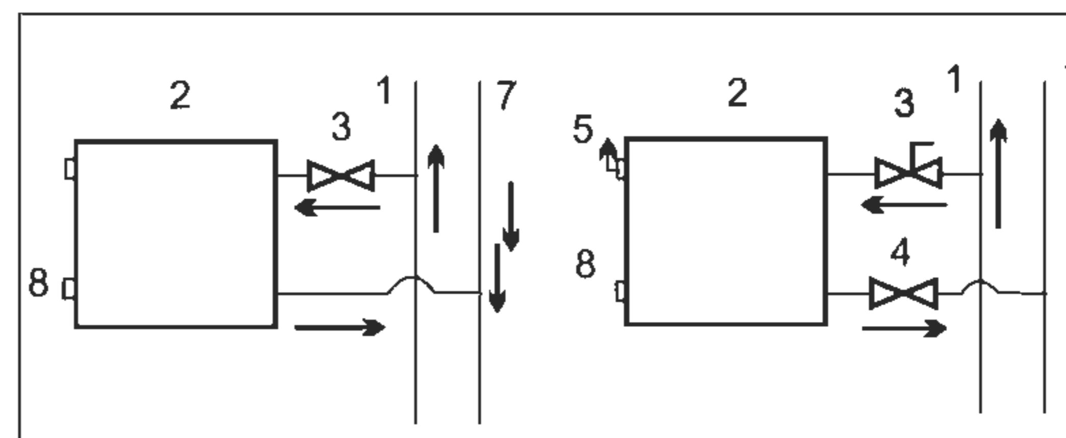
в — двухтрубная система, г — двухтрубная система, стандартное подключение рекомендуемое подключение
